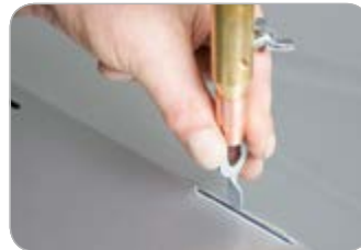
Schnelles Aufsetzen von MIRACLE-Bits / Einziehen
