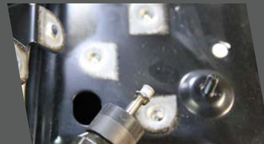
Spezial-Zugbolzen für das Ziehen von Stanznieten schnell und sicher aufschweißen. (Separates Zugwerkzeug erforderlich)
