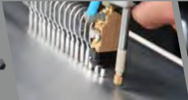
Speziell legierte Alu-Bits anschweißen
