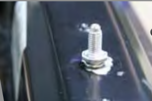
Gewinde- und Massebolzen aus Stahl / Alu bis zu \varnothing 10 mm setzen
