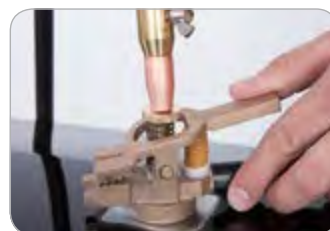
Elektrodensatz inklusive A: MS-U-B14 / Kohlestift 2x B: MS-U-B15 / Spitze C: MS-U-B12 / Stauchelektrode D: MS-U-B11 / Bithalteelektrode
