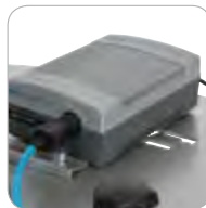
CZ-160b Netzadapter (WAECO) Eingangsspannung: 220–240 V Ausgangsspannung: 13 V Dauerbelastbarkeit: 6 A Abmessung (BxHxT): 115 x 65 x 170 mm
